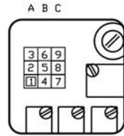
FIGURE 7-4 GFC57/67/77 CALIBRATION POTENTIOMETER AND JUMPERS
