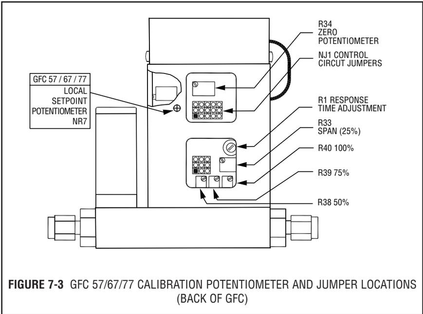
**FIGURE 7-3** GFC 57/67/77 CALIBRATION POTENTIOMETER AND JUMPER LOCATIONS (BACK OF GFC)
