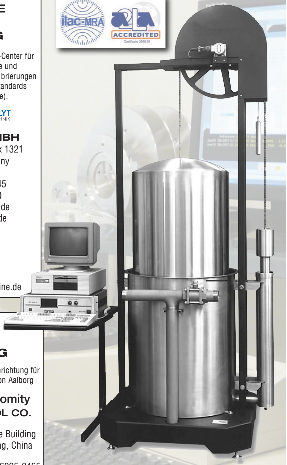
Typische Prüfglocke für Kalibrierungen nach NIST-Standards
